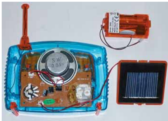
Radio-Rückseite, Solarpanel und Batteriebox.
