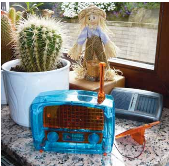
Radio hören mit der Kraft der Sonne: das fertig aufgebaute Solarradio. Fotos: Klaus Fuchs
