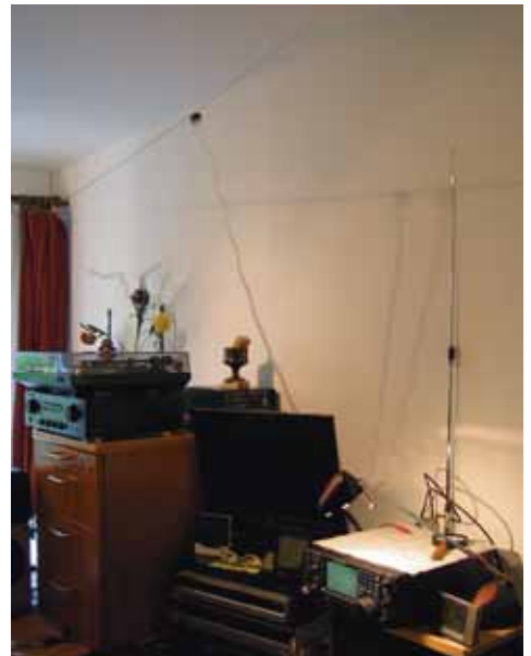
Ein Dipol quer durch den Raum gespannt: Wo es möglich ist, ist es ein durchaus funktionierender Notbehelf.
