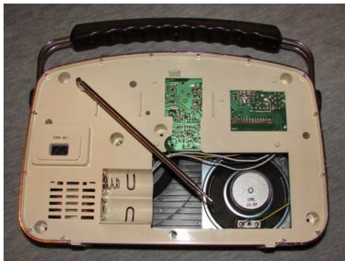
Innenansicht bei abgeschraubter Rückwand, links Netzteil, oben Radioplattine und rechts Lautsprecher Foto: Fuchs
