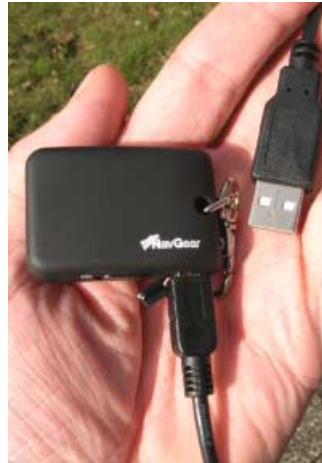
Per USB-Kabel lässt sich der GPS-Mini-Empfänger aufladen.
